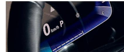
La nuova strumentazione LCD IPS, completamente digitale, fornisce una perfetta panoramica delle funzioni, tra cui: contachilometri, odometro, indicatore del livello della batteria, indicatore del recupero e molto altro.
